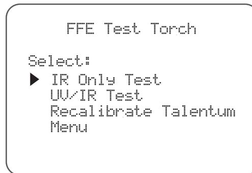
L'écran principal vous permet de sélectionner un **test IR**, un **test UV/IR** ou de **recalibrer** votre détecteur de flamme Talentum.
