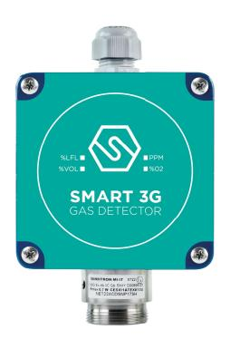
Le détecteur de gaz SMART3G-C3 est conçu pour répondre aux exigences industrielles ; le boîtier est antidéflagrant et peut être installé en zone ATEX 2 et, lorsqu'il est équipé d'un adaptateur anti-poussière, en zone 22. L'élément sensible est placé dans une tête en acier inoxydable de 40 mm de diamètre. Les capteurs Pellistor utilisés pour la détection des gaz inflammables présentent une excellente linéarité de sortie jusqu'à 100 % LIE et un temps de réponse rapide.
